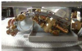
Kit hidráulico montado y cableado
